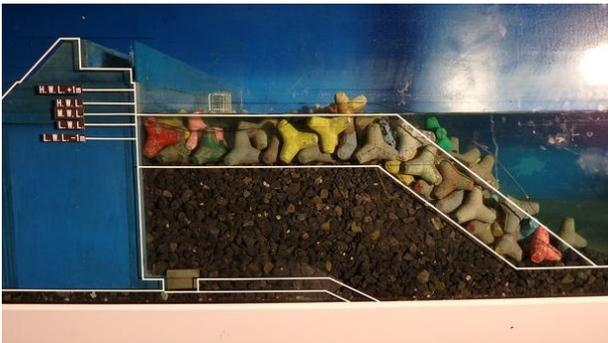
写真-1 消波ブロック1層を移動させた没水型の実験断面
