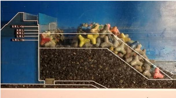
写真-2 消波ブロック2層を移動させた没水型の実験断面
